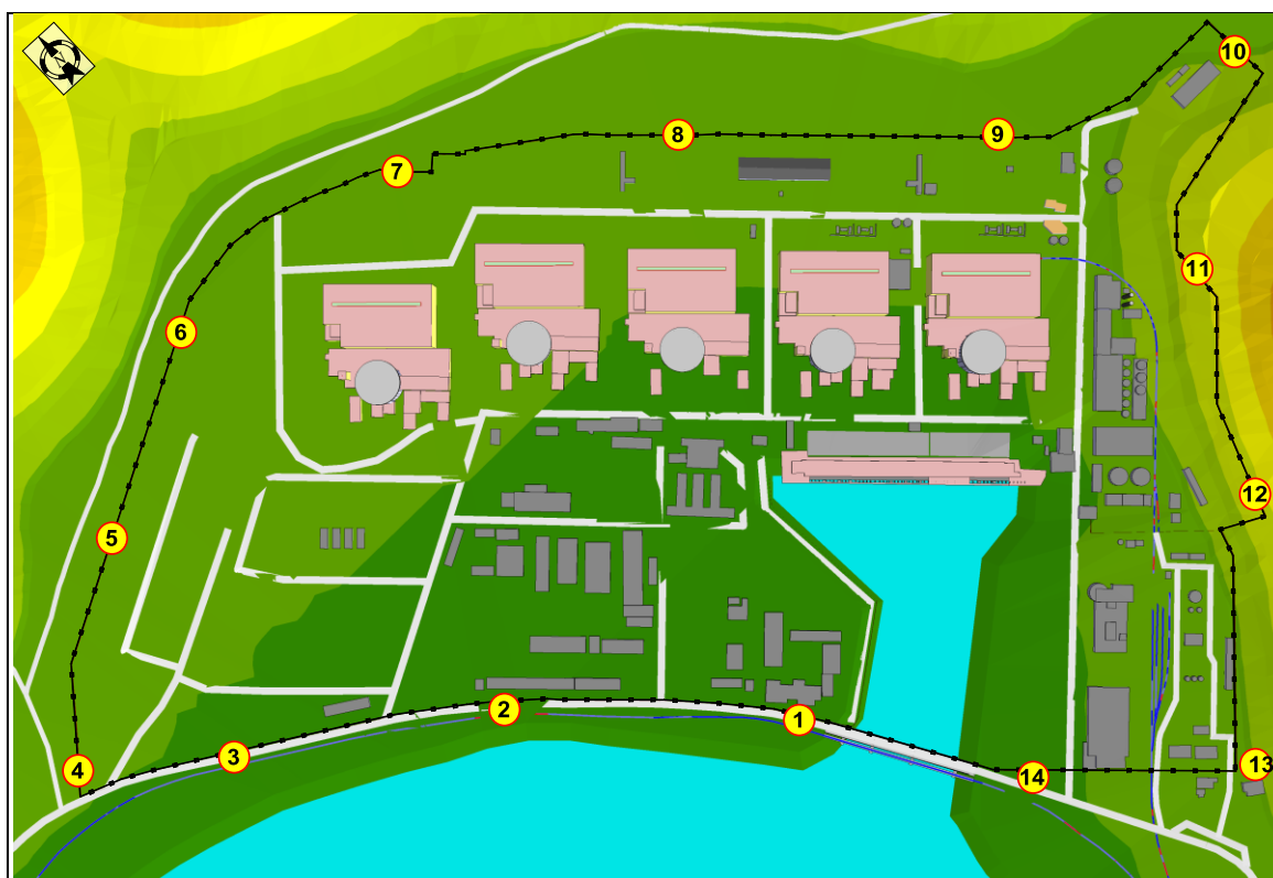
Fig. 14 Distribuția punctelor de măsurare a nivelurilor de zgomot la limita incintei CNE Cernavodă, în acord cu SR 10009:2017
