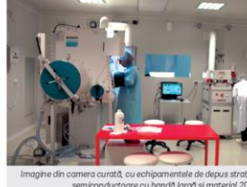
Imagini din camera curată, cu echipamentele de depunere subțiri din materiale semiconductoare cu bandă largă și material 2D-grafen.
