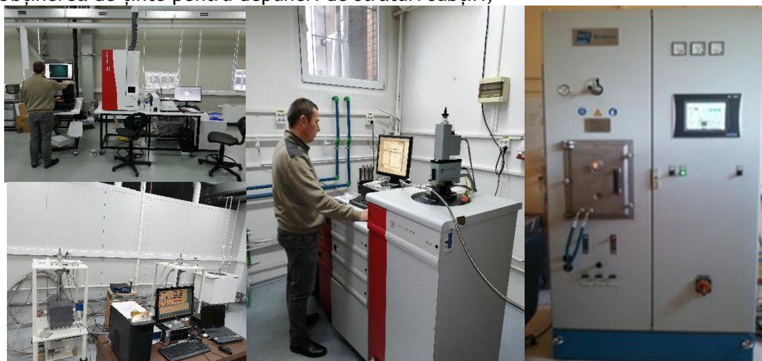
Fig. 30-1 ICP-MS cu AL pentru filme subțiri (stânga sus), spectrometre Mössbauer cu criostate cu circuit închis de He (stânga jos) și dispozitiv SQUID - Quantum Design, de înaltă sensibilitate (mijloc). Instalație de sinterizare în plasmă folosită pentru obținerea de materiale de densitate ridicată, cu păstrarea caracteristicilor nanostructurale (dreapta).
