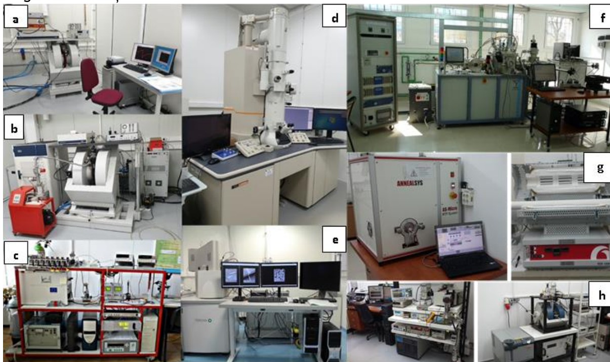
Fig. 70-1 (a) Spectrometru RES Bruker în banda X în regim pulsant cu accesorii ENDOR; (b) Spectrometru RES Bruker în undă continuă în banda Q cu accesorii ENDOR; (c) Sistem de măsurări electrice în atmosferă controlată cu ajutorul unei stații de mixare a gazelor; (d) Microscop electronic analitic de înaltă rezoluție JEM 2100; (e) Sistem dual SEM-FIB Tescan Lyra III; (f) Echipament de depunere de straturi subțiri prin pulverizare cu magnetron, cu AES, LEED și elipsometrie in situ; (g) Echipament de procesare termică rapidă (RTA, RTO, RTN), cuptor cu 3 zone de temperatură pentru PVD; (h) Standuri de măsurări electrice și fotoelectrice, măsurări Hall și de magnetorezistență.
