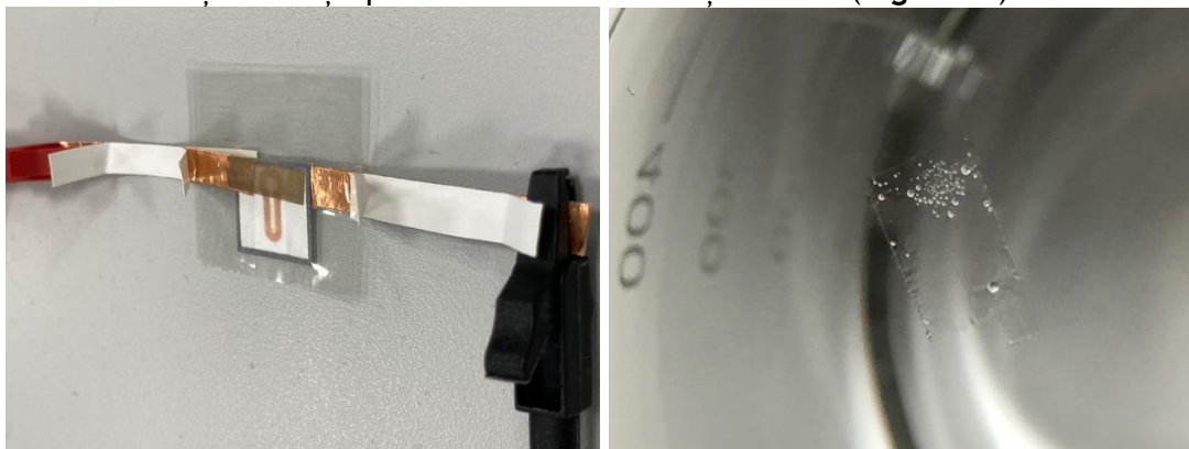
Fig. 10-1 Stânga - biosenzor pe suport de hârtie și sistem de electrozi metalici fibrilari obținuți prin electrofilare; dreapta - folie de grafenă/PMMA exfoliată electrochimic, pregătită de transfer.
