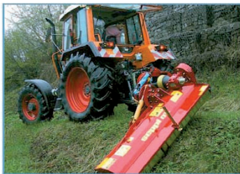
Montare opțională pentru SMWA-avs la PTO frontală (reverse drive)
