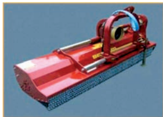
Masina reversibila cu cadru culisabil in lateral prin acționare hidraulică
