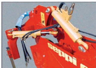
Posibilitate de pendulare laterala prin actionare hidraulica
