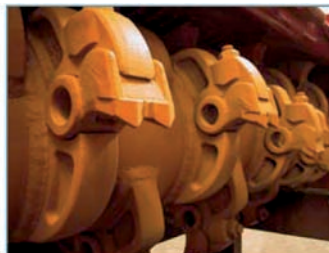
Rotor cu cutite fixe montate pe suporturi masive, forjate, disponibil pentru Miniforst, Midiforst și Midiforst d.t.
