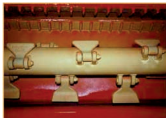
Rotor OLS cu ciocane montate în spirală și contracutite
