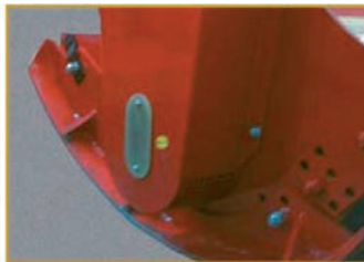
Aparatoare curele de antrenare cu ventilatie de racire, sine optionale și matura hidraulică
