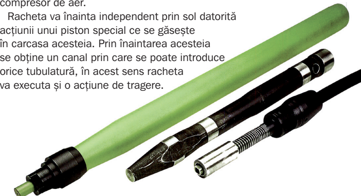
IP 155 cu cap săpător de bază, pentru tubulatura de \varnothing 150 – 200 mm
