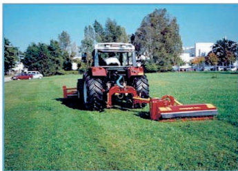
Combinatie între un SMO-fh și SMWA-avs, latime totală de lucru 4,5 m
