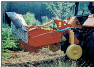
Optional: roți de sprijin pentru o mai bună stabilitate în timpul lucrului
