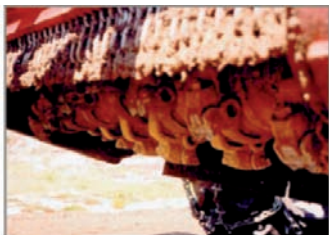
Rotor cu ciocane fixe ce permit eliminarea gropilor și a hopurilor din drum.
