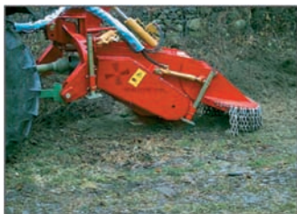
Deschidere hidraulica a plăcii posterioare pentru o mai bună apropiere de cioata
