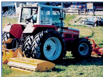
Combinarea unui SMG cu un mulcer montat frontal in vederea obtinerii unei latimi de taiere extinse.
