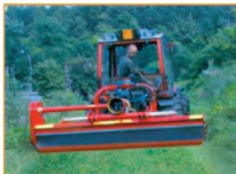
Placă posterioară de închidere reglabilă, prevăzută cu perdea de cauciuc
